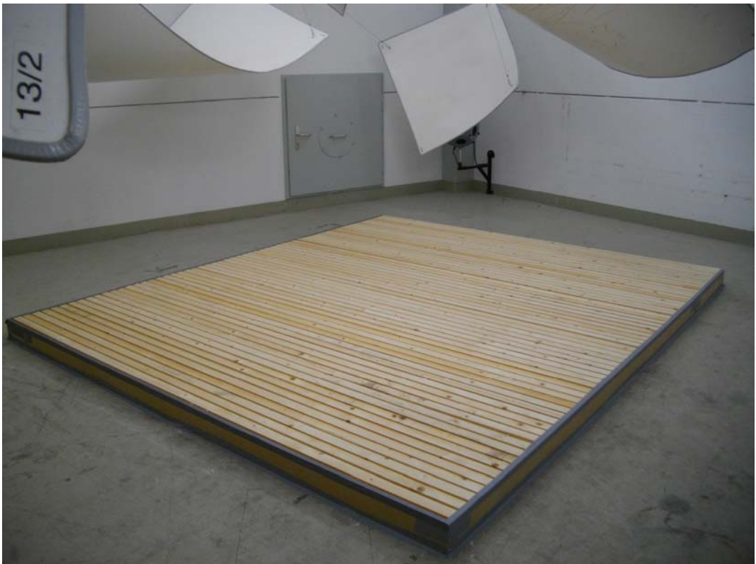
Abbildung B2. Aufbau 2 im Hallraum
